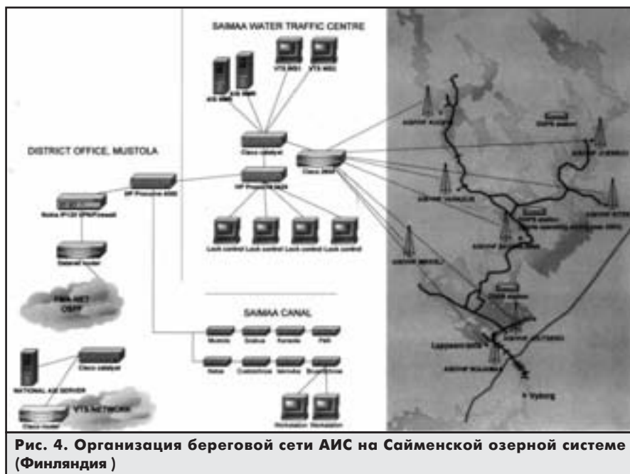
Рис. 3. Структура береговой сети АИС
