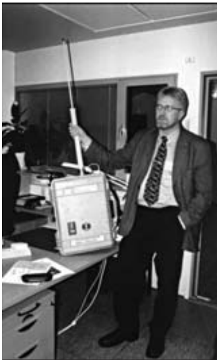
Рис. 6. Использование лоцманского транспондера при проводке судов на Панамском канале
