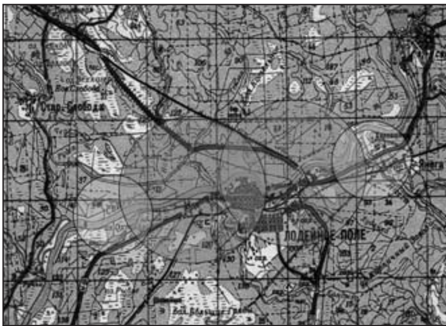
Рис. 5. Использование двух береговых станций АИС и пониженной мощности судового транспондера для устранения перегрузки радиоканала АИС (пример)
